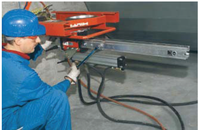
Speichererweiterung aufsetzen und mit Exzenterbolzen klemmen
